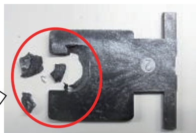
ロックプレートが破損している
