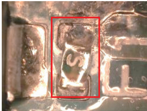
ヒューズの破損事例
