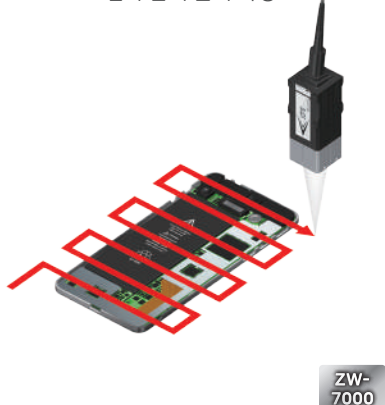
조립 부품의 높이 측정
