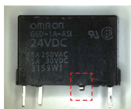
リレー端子の変形
