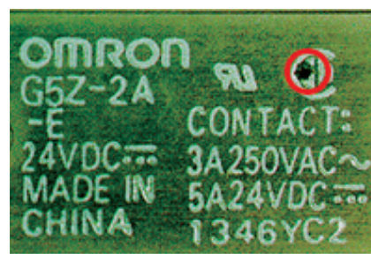
リレー端子によるケース穴開き
