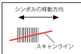
傾斜したピケットフェンス
