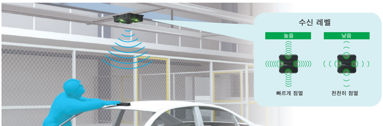
리더/라이터의 LED를 보면서 수신 레벨이 높아지도록 RF 태그의 설치 위치를 조정
